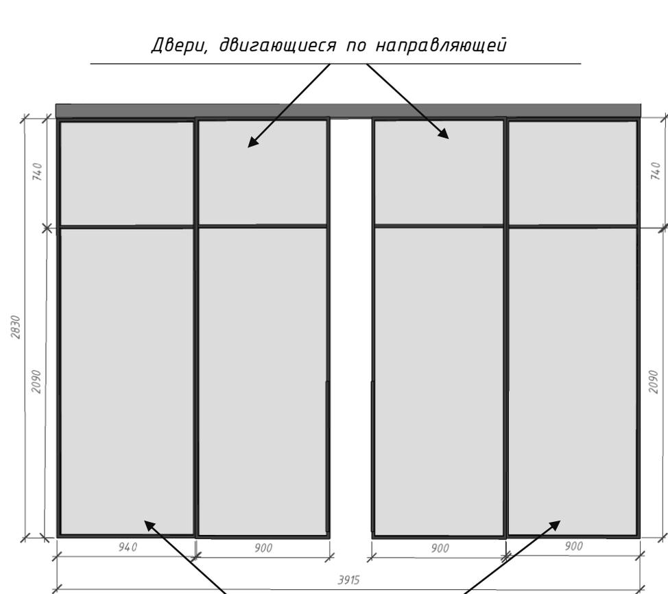
*Неподвижные двери, закреплены плотно к полу и потолку*
